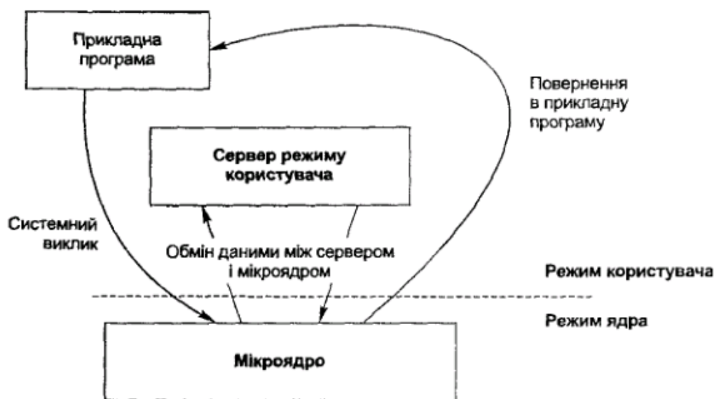
Рис. 2.1. Виконання системного виклику в архітектурі з мікроядром
